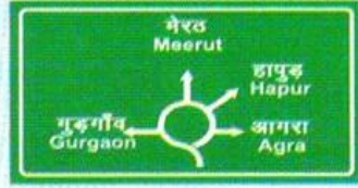
गोलचक्कर चौराहे पर अग्रिम गंतव्य का चिन्ह Advance Destination Sign on Rotary Intersection
